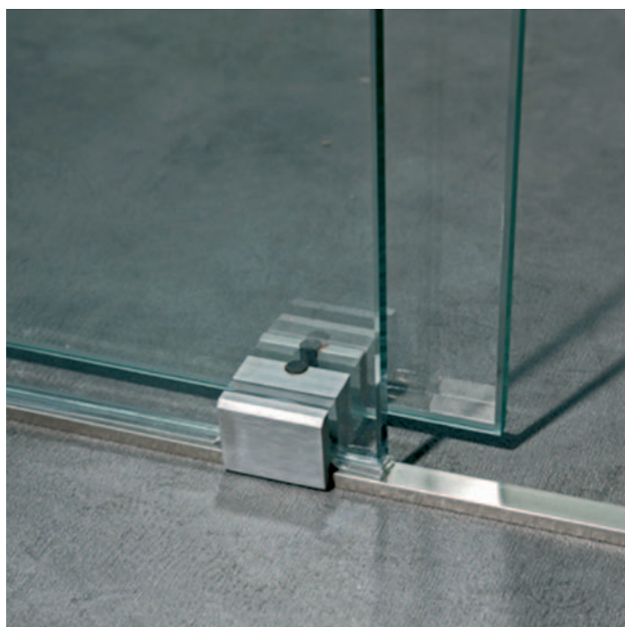
Un composant fondamental : la pince et guide au sol. Elle retient la glace fixe de façade et guide la porte sans vibration ni bruit parasite, garantie de la meilleure qualité perçue.
