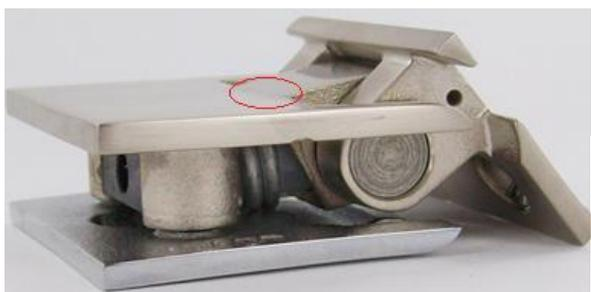
Foto eines REVERSI Scharniers, welches über den 90°-Öffnungswinkel hinaus überdreht worden ist.
