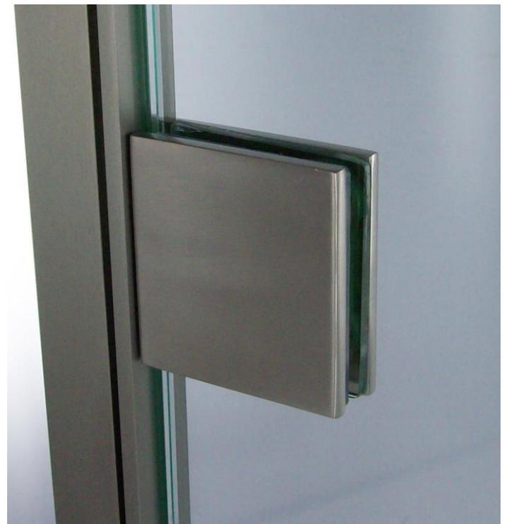
**Klemme auf Ausgleichsmauerprofil (25 bis 32 x 25)** Die quadratische Klemme (57x57) weist dieselbe Größe wie das Scharnier auf: einwandfreie Homogenität, reines Design, nüchterne Linien. Wie das Scharnier, welches auf ein Ausgleichsprofil geschraubt ist, ist die Klemme von hinten an das T-Profil geschraubt. Der bewegliche Teil des Profils und die Klemmen bilden nunmehr eine einzige Einheit.
