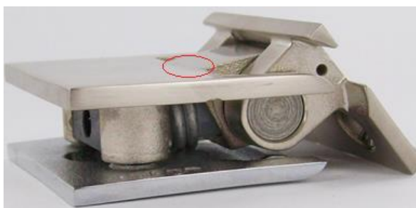
Photo d'une charnière REVERSI forcée au-delà de 90° d'ouverture.
