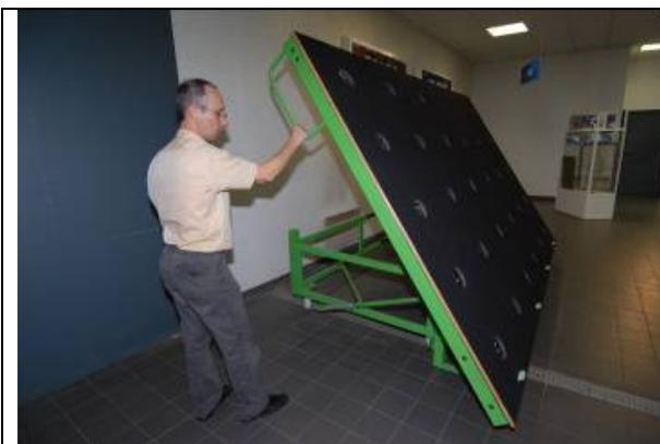
Basculement de la table à l'aide des poignées / *Tipping down the table using side handles*
