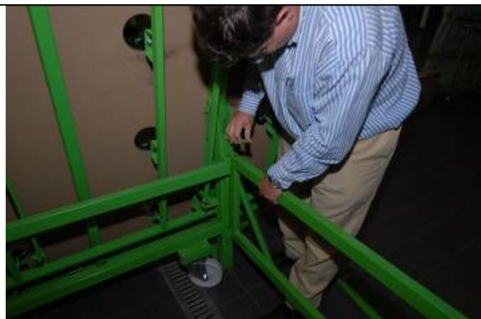
Ouvrir à 90 ° les montants du châssis et venir réunir les deux parties du châssis avec les tiges de goupillage coudées qui s'insèrent verticalement dans leurs gâches. *Open frame sides with 90 ° angle and unify both parts of the frame together sliding bended rods into their sockets*
