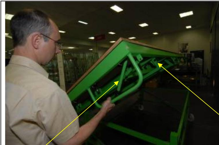
Poignée de déverrouillage pour permettre l'inclinaison de la table. Encoche de verrouillage visible en bout de tringlerie, à l'extrémité de la table / *Unlocking handle to allow tipping of the table. Notch can be seen under the edge of the table*
