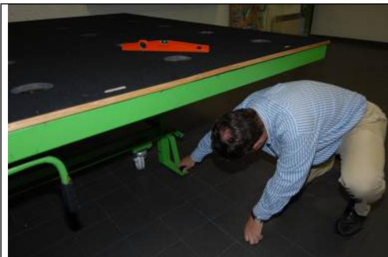
Ajustement du niveau des pieds à l'aide de vis à embout / *adjusting level using tipped screws*
