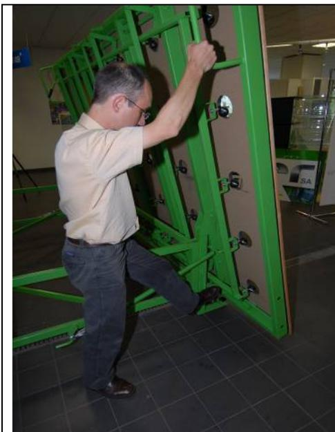
Pédale de déverrouillage pour permettre le retour de la table en position horizontale.
