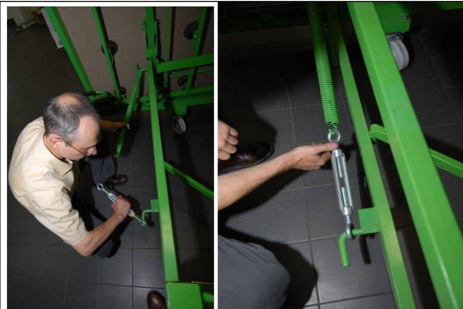
Montage des ressorts avec leurs tendeurs / *Setting up springs with stretching devices.*
