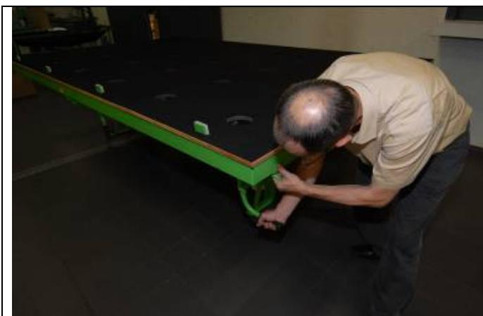
Manoeuvre de sortie des butées avec double poignée pour prévenir la rétraction accidentelle des butées / Double handle allowing exit movement of retractable stop pads but preventing unwanted stop pads retraction.
