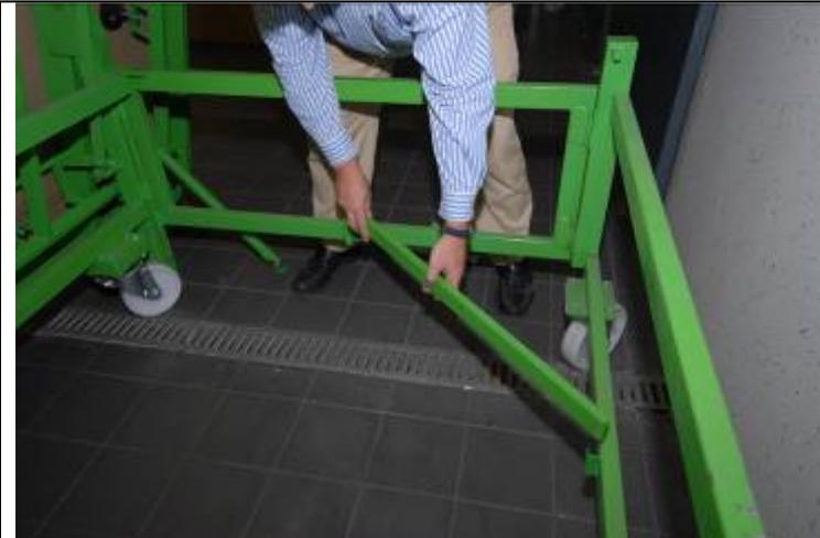
Insérer les raidisseurs d'angle / *Insert angle stiffeners*
