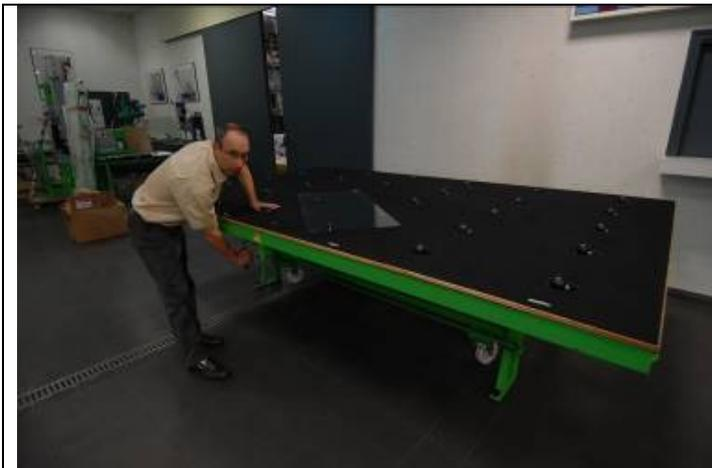
Poignée permettant la manœuvre de sortie des poupées / handle allowing exit movement of castor balls
