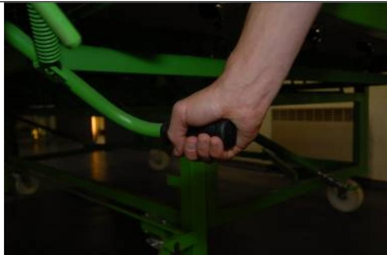
La poignée ne peut être actionnée qu'après libération de la sécurité/ *Handle can not be used unless security lock has been removed*
