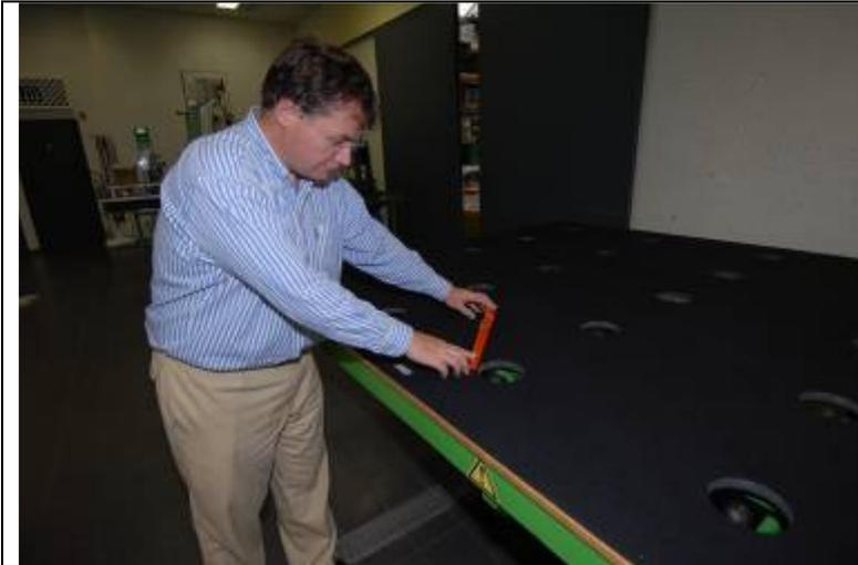
Mise à niveau de la table avec un niveau à bulle / *levelling table using a spirit level*
