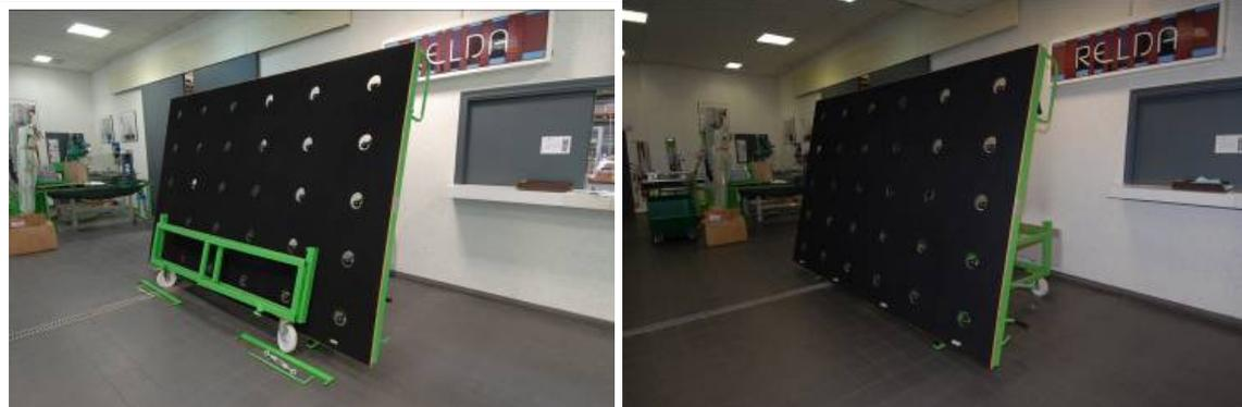
Table de coupe en position verticale avant et après assemblage avec vue des éléments du châssis à monter / *Cutting bench in vertical position before and after being assembled with detailed view of individual frame components*
