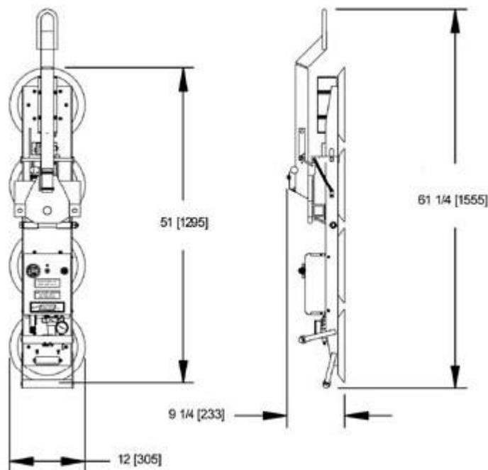
Ces palonniers POWR-GRIP®, basculant (90°) – rotatif (180°) offrent un concept modulaire et peuvent être adaptés simplement à des applications très variées sur chantier comme en atelier. Modèle léger idéal pour la pose de cloisons, vitrines,...
