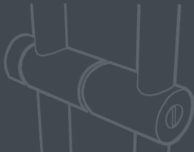
Les poignées Adlock se déclinent en standard jusqu'à 6m de haut, du diamètre 20 au 45mm, en inox poli ou brossé, avec le nombre d'entretoises souhaité. Des principes de construction optimisés et brevetés. Un must : la serrure de sécurité à hauteur d'homme, intégrée dans le tube intérieur, qui verrouille sans effort la porte en 2 points haut et bas. Disponible sur stock ou fabrication rapide.
