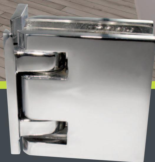
Les charnières à rappel permettent d'articuler une porte qui se referme automatiquement après ouverture. Ce rappel peut être isodouche® (effectif sur une plage d'ouverture limitée autour de la position de rappel : généralement +/-15°, jusqu'à +/-40° avec le modèle CAPSI), saloon®(sur +/-90°), ou super saloon® pour un rappel saloon précis de portes lourdes, voire amorti pour une fermeture douce.
