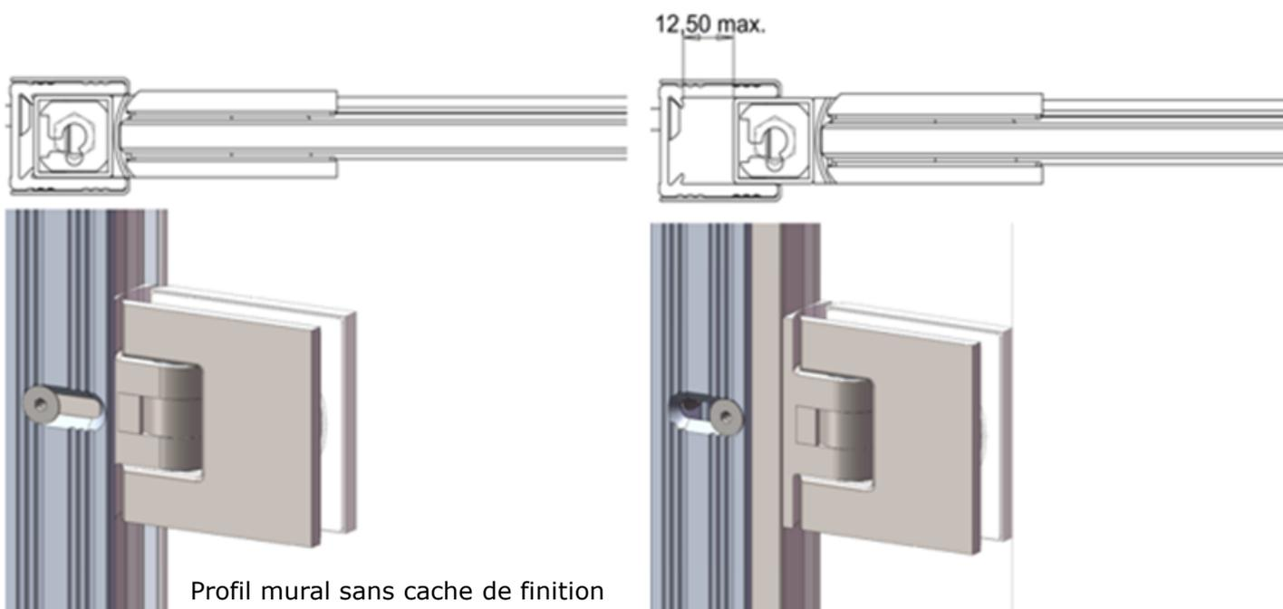
Ce montage permet de compenser autant de défauts cumulés de mesures de largeur de la paroi et de verticalité des murs d'appui.
